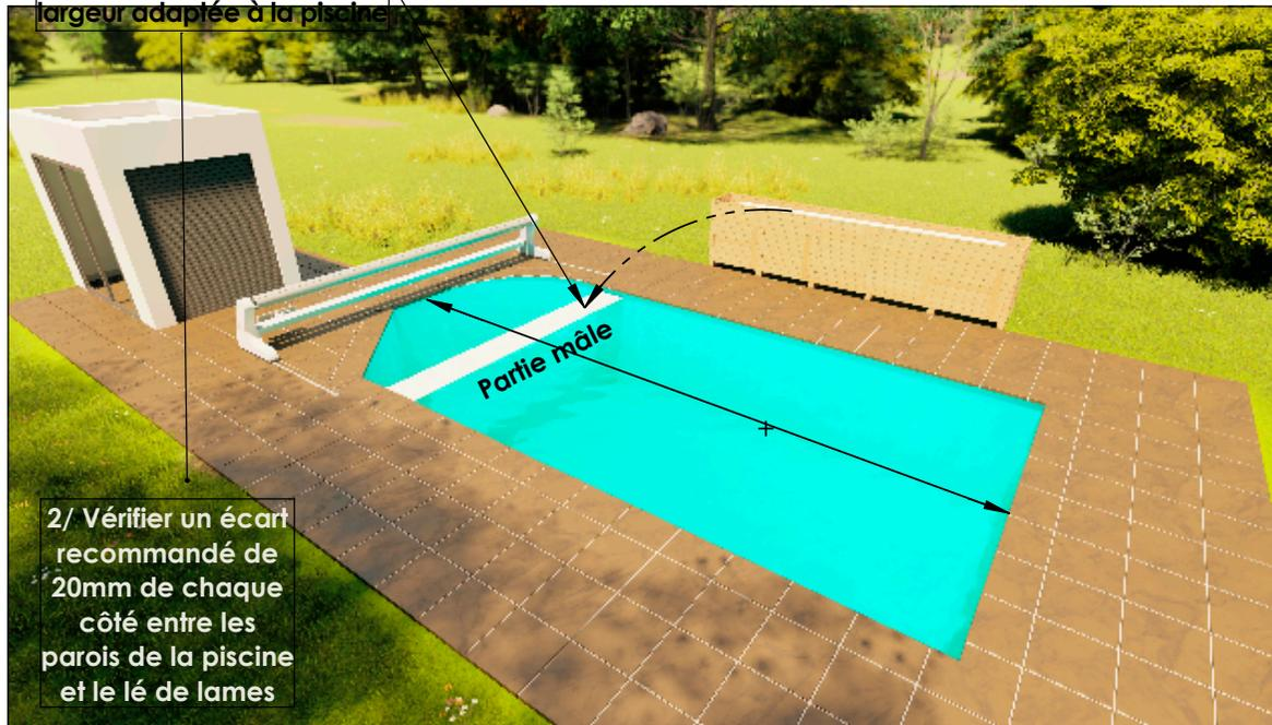
Mise en place de ski de guidage de lames pour enrouleur hors-sol :
