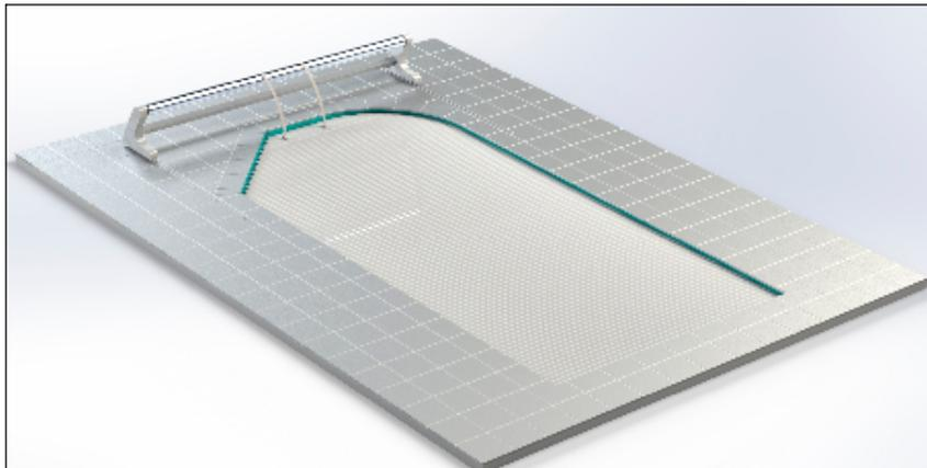
**Etape 3:** Lorsque la couverture est arrivée en bout de piscine, reculer manuellement l'enrouleur jusqu'à sa 1<sup>ère</sup> position tout en laissant le déroulement de la couverture actionné. La couverture recouvrira donc la partie de la piscine ayant des pans coupés ou rayonnés
