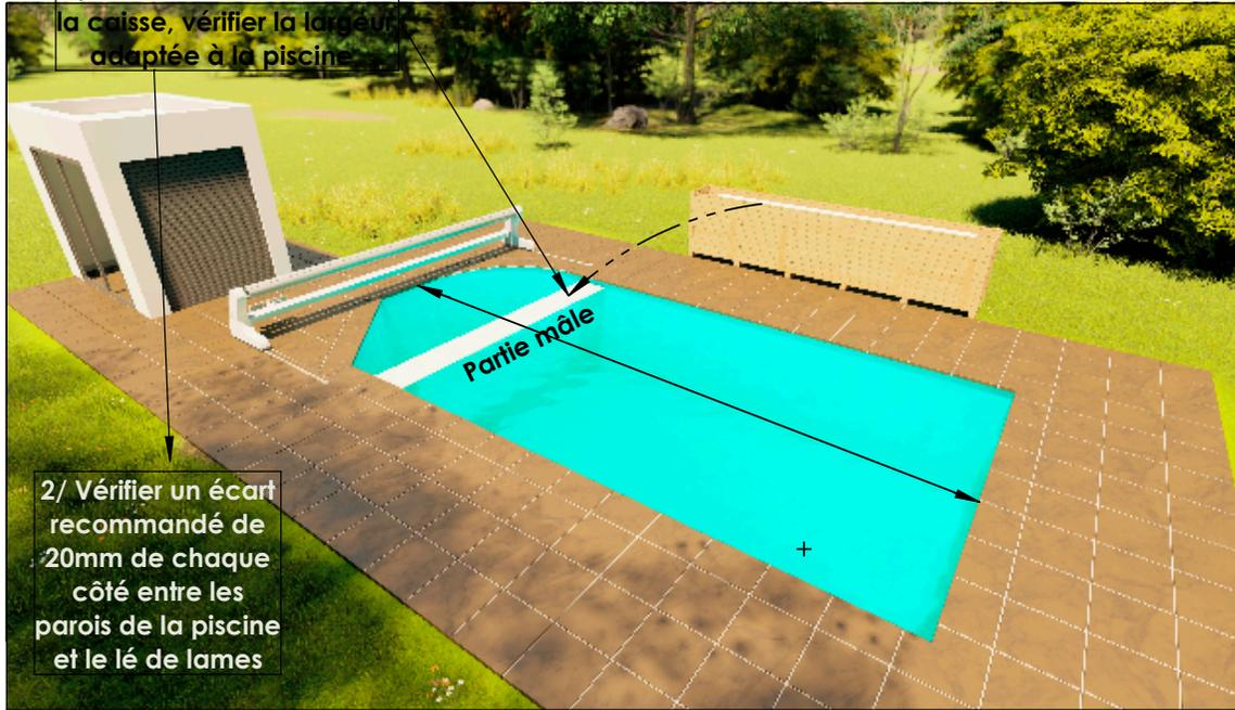
2/ Vérifier un écart recommandé de  $\pm 20$ mm de chaque côté entre les parois de la piscine et le lé de lames
