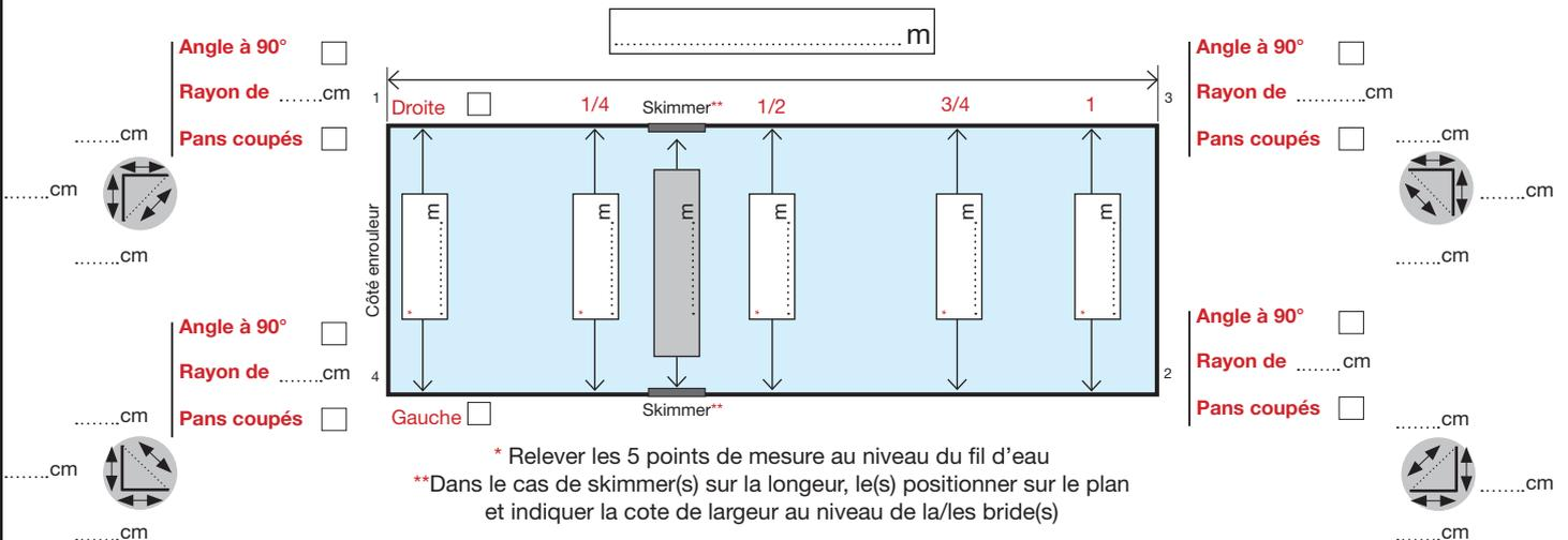
\* Relever les 5 points de mesure au niveau du fil d'eau
