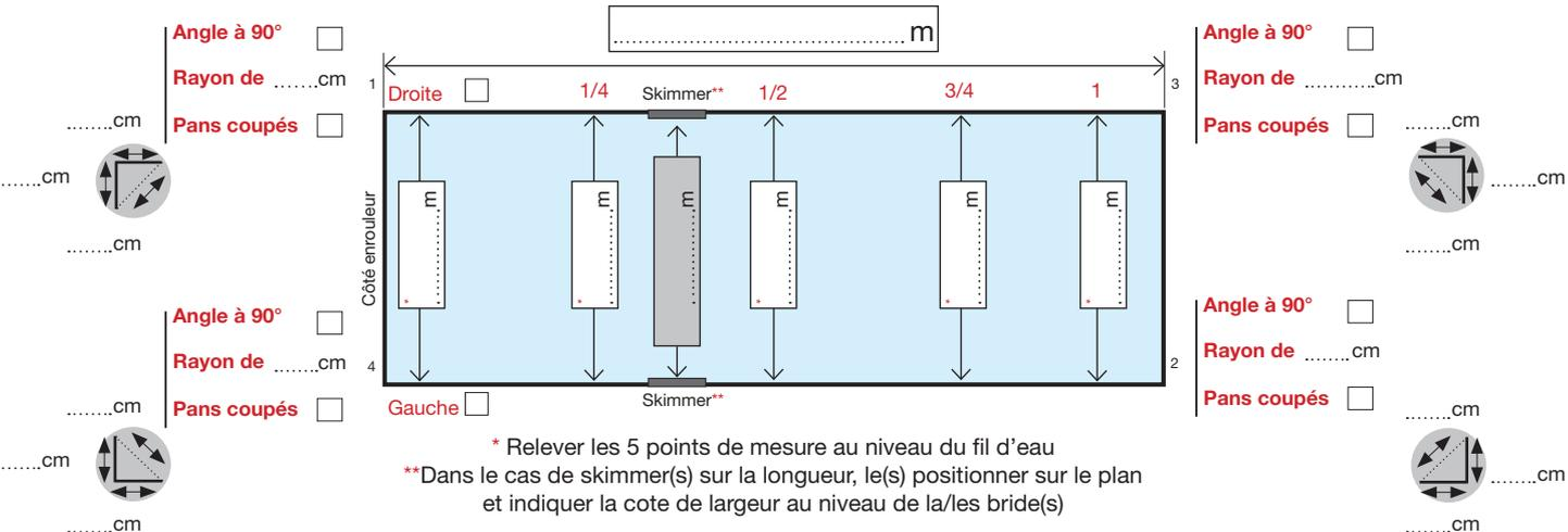
\* Relever les 5 points de mesure au niveau du fil d'eau
