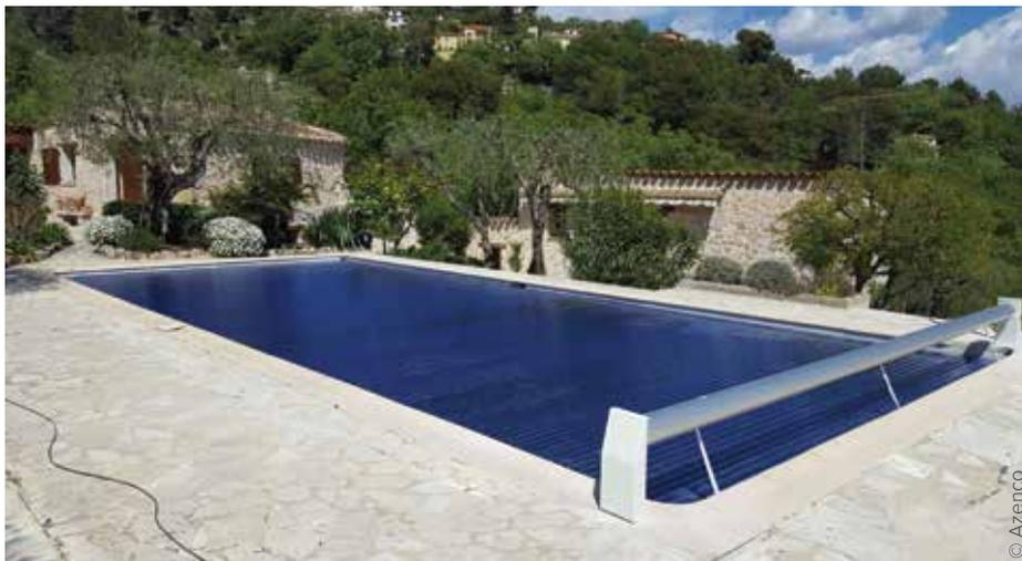
**Les lames en polycarbonates sont plus résistantes aux chocs et aux UV, donc plus durables que les lames en PVC, mais présentent également un coût supplémentaire. En plus d'assurer une isolation thermique, les lames en polycarbonates solaires, permettent de gagner quelques degrés supplémentaires et chauffer l'eau.**
